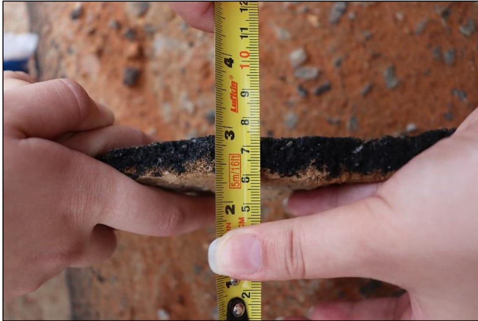
Figura 123 – Espessura da amostra de pavimento. Fonte: Diligência 22 de setembro.
