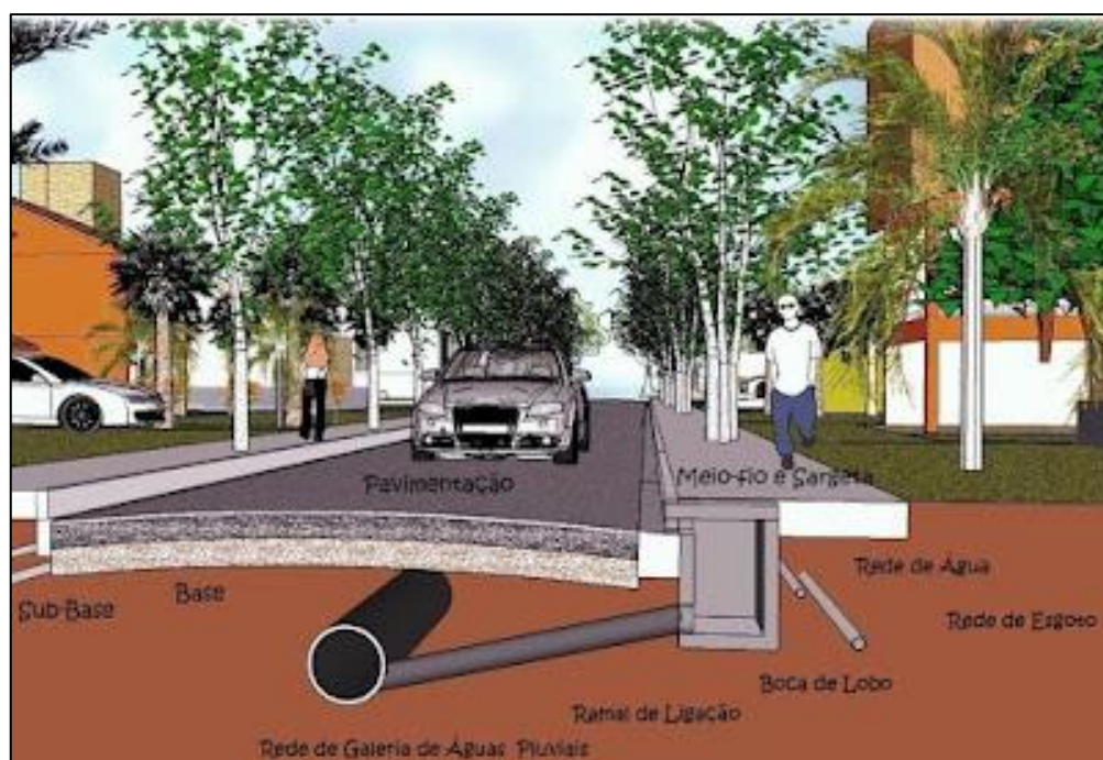
Figura 76 - Corte esquemático de uma via e sistema que compõe a microdrenagem. Fonte: Aguiar (2017).
